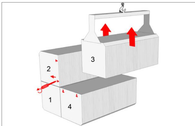
Bild 2: Remove bolt screws
